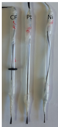
Σχήμα 2. Αριστερά: Ηλεκτρόδια ινών άνθρακα (CF), λευκοχρύσου (Pt) και νικελίου (Ni) σε ίνες άνθρακα. Δεξιά: Αναγωγή προς αέριο υδρογόνο στα ηλεκτρόδια (διάλυμα 1M HClO 4 , ταχύτητα σάρωσης 5 mV/s).
